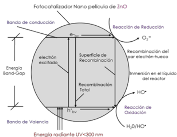
FIGURA 2. Proceso de Fotocatálisis [8]
