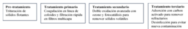
FIGURA 5. Diagrama de bloques del tren de tratamiento de la PTAR por Doble Oxidación Avanzada.
