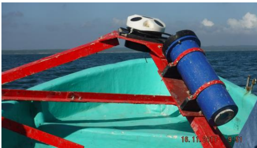
Fig. 1. Perfilador de olas y corrientes fondeado en el norte de Veracruz.
