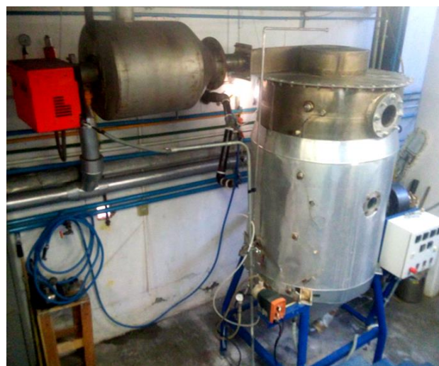
Figura 7. Acoplamiento del quemador de gas L.P. a la cámara de combustión y el dispersor de gas-aire.
