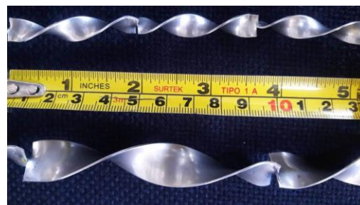
Fig. 3.- Cintas torcidas, abajo TT2 y arriba TT3
