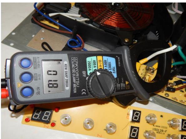
Fig. 4 Consumo de energía eléctrica en modo "Stand by" de estufa de inducción conectada a CA (1.8 Amperes).
