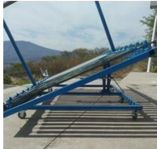
Fig 3. Prueba de funcionamiento del colector solar
