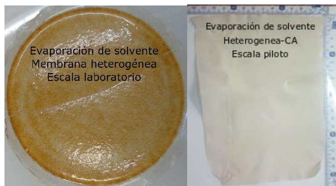
Fig. 1. Imágenes de las CEM (a) heterogénea y (b) heterogénea-CA, sintetizadas
