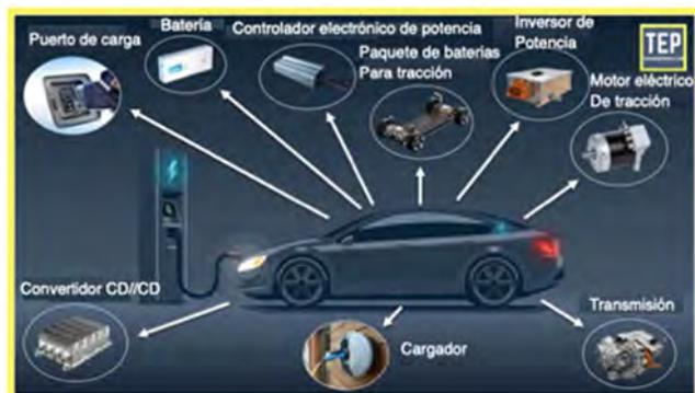
FIGURA 6. Automóvil eléctrico y partes que lo conforman [18].
