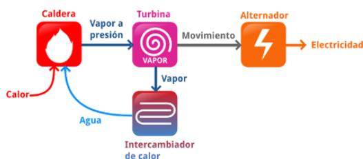
FIGURA 1. Proceso de una termoeléctrica [5].
