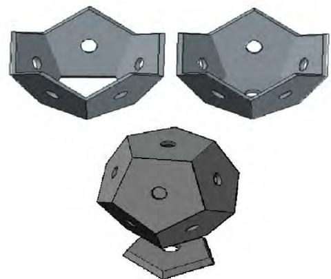
FIGURA 3. Dibujos 3D en Autocad, de las mitades inferior (arriba izquierda) y superior (arriba derecha), y dodecaedro completo con cara pentagonal como base.
