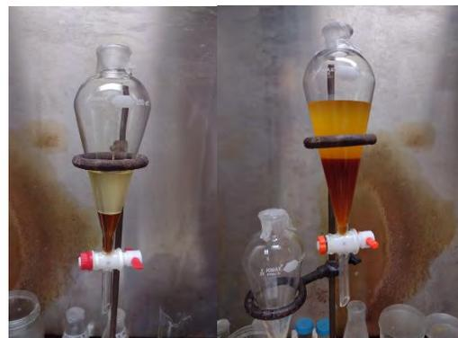
FIGURA 6. Separación de productos de la reacción de transesterificación
