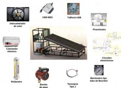
Figura 4. Elementos del banco de pruebas. Fuente propia [3].
