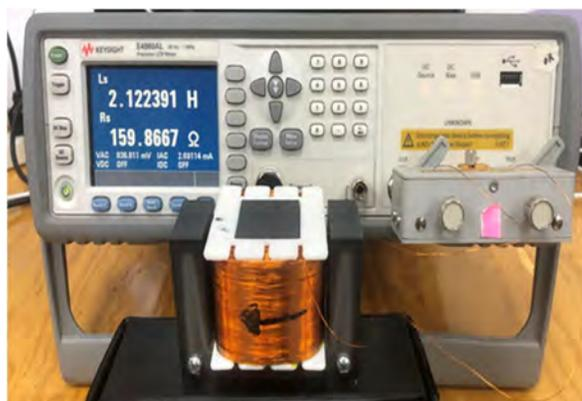
FIGURA 10. Medición de inductancia con el LCR E4980AL.
