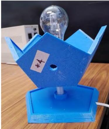
**FIGURA 6.** Mitad inferior de dodecaedro, acoplada a una sexta cara pentagonal como base, en la cual se ha fijado el socket y el foco. La base de la lámpara tiene una ranura para alojamiento del cable calibre 18.
