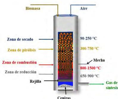
FIGURA1. Esquema Del Reactor Estratificado de biomasa
