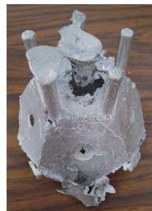
**FIGURA 9.** Mitad superior del dodecaedro fundido en molde de arena, tal como se desmoldea después de la solidificación. Se aprecia la colada al centro y cinco alimentadores periféricos para asegurar el llenado del molde.
