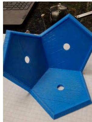
**FIGURA 8.** Impresión de tres caras para la parte superior del dodecaedro, con filamento PLA.
