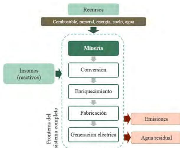
**FIGURA 2.** Ciclo del conversión del uranio a combustible nuclear (*Front End*).
