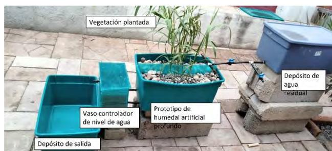
**FIGURA 3.** Prototipo de humedal artificial profundo.
