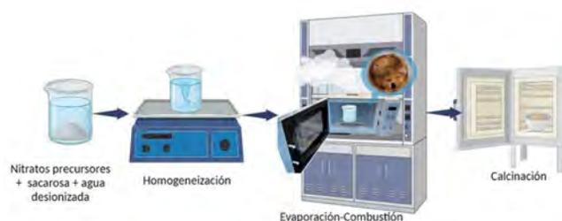
**FIGURA 1.** Esquema general de síntesis de perovskitas por combustión asistida con microondas.
