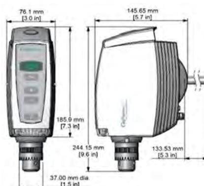
FIGURA 2. Caframo utilizado para las validaciones de potencia [7]
