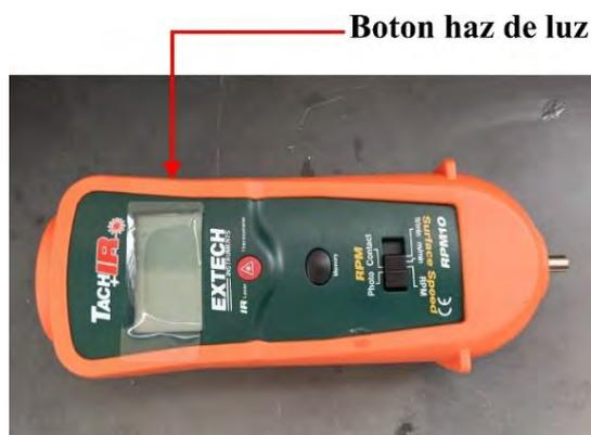
FIGURA 4. Tacómetro digital ExTech modelo RPM10.
