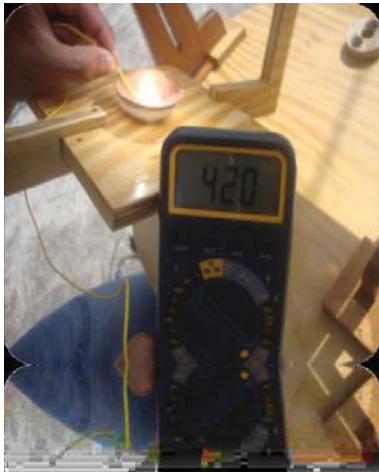
Fig. 21. Fusión de polvo de zinc comercialmente puro, mediante ESC usando el prototipo de concentrador solar tipo Lente de Fresnel, mostrado en la Fig. 20
