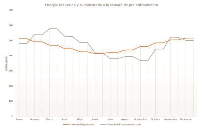
Ilustración 2. Energía requerida y suministrada a la cámara de pre enfriamiento.
