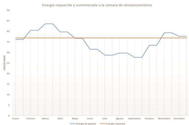
Ilustración 4. Energía requerida y suministrada a la cámara de pre enfriamiento.
