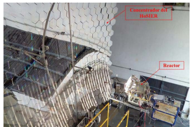
Figura 8. Reactor solar en la prueba experimental y montado en la mesa del HoSIER.
