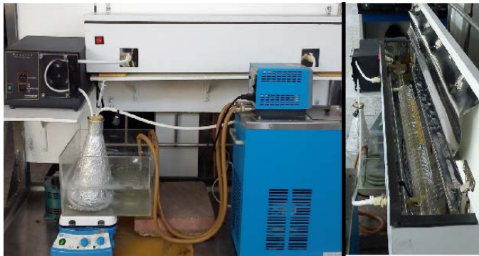
Fig. 2. Sistema de fotodegradación de la solución de 4-Clorofenol (sistema semicontinuo).
